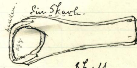
Ein Skavle reids kaptif på skjere eller skave av bork til krøter. Han er laga av ein ubrent, ubrotten gjå. I median har brukt og kvest endane, so vert dei sett i på eit frekkatt. Skavlen kan også brukt til å skave borken av hestehauar, til å skave eller hale ut ei skei eller ei ause.
